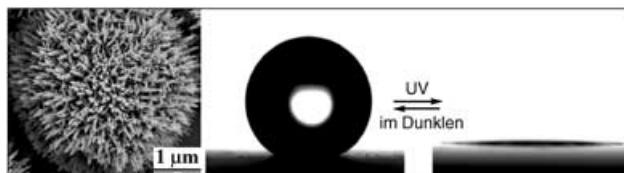
**Nass oder trocken:** Filme aus Titandioxid-Nanostäbchen mit mikro- und nanoskaligen hierarchischen Oberflächenstrukturen (links) sind superhydrophob (Mitte), sie werden aber reversibel superhydrophil (rechts), wenn sie UV-Licht ausgesetzt
